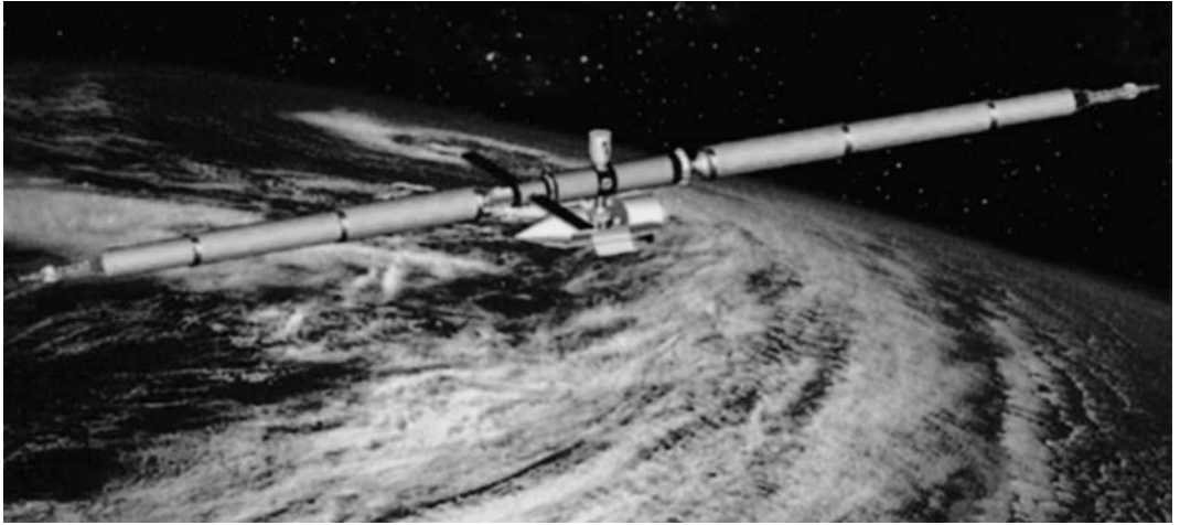
Межпланетный корабль с двумя независимыми ядерными электроракетными двигателями, предназначенными для повышения надежности перелета на околоземной орбите.
